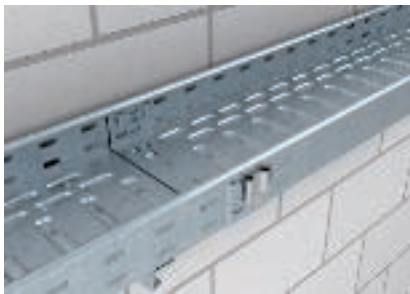
Egymásba tolható csatlakozás, csak a füleket kell lehajtani
