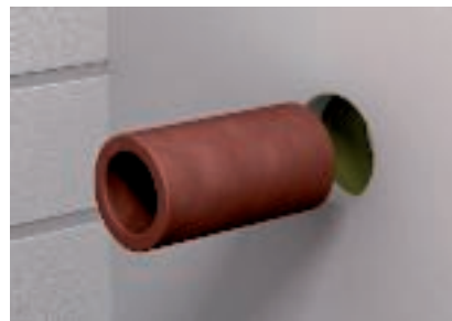
A csőháj beillesztése a szerelt falba
