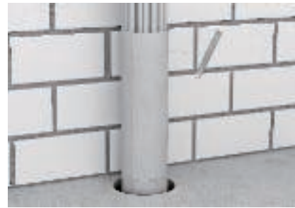
A bandázs rögzítése kötöződróttal
