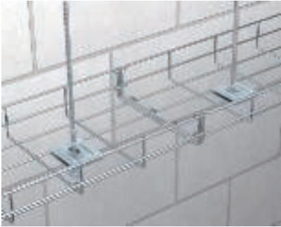
Középpontosan függesztett tartó Rácsos kábeltálca felfüggesztése 2078 típusú menetes rúddal és K12 1818 típusú fali és padló rögzítővel. Alkalmazás 200 mm szélességig.
