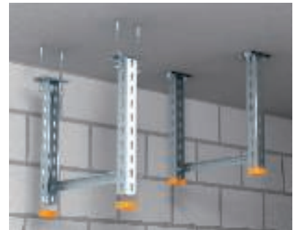
Egyedi tartószerkezet Egyedi tartószerkezet kialakítása: US 3K, US 5K és US 7K típusú, dübelekkel mennyezetre függesztett oszlopokkal, és a megfelelő US 3, US 5 illetve US 7 profilból készült kereszttartó felhasználásával.
